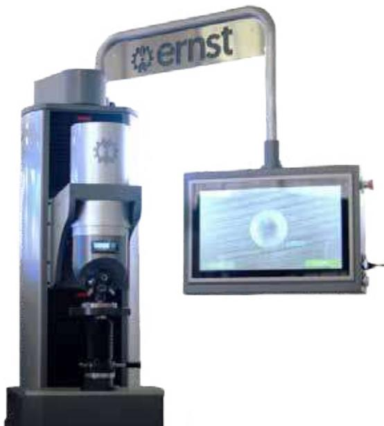
Eagle 3000 è un durometro completamente automatico, conforme alle norme Brinell DIN ISO EN 6506 e ASTM E-10.
