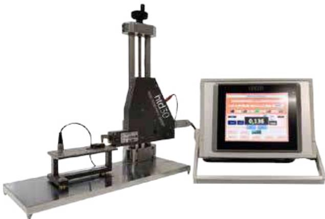
HTD30, progettato per offrire risultati rapidi in meno di un minuto, elimina la necessità di operazioni lunghe come sezionatura, inglobamento e lucidatura, preservando l'integrità del pezzo di lavoro.
