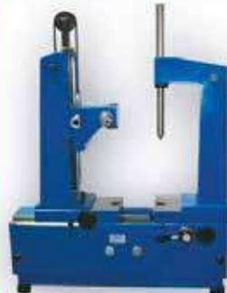
Il controllo di ingranamento è un controllo funzionale; possiamo offrire ingranometri monofianco o bifianco. Il bifianco è indicato per il controllo di ingranaggi cilindrici, il monofianco per il controllo di ingranaggi cilindrici, vite-corno e conici; viene eseguito con master di misura o ingranaggio coppia.
