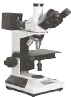
Microscopio metallurgico trinoculare verticale con ottica piana ed illuminazione a luce incidente. Particolarmente adatto per situazioni che richiedono una visuale verticale. Microscopio funzionale con nitidezza sorprendente.
