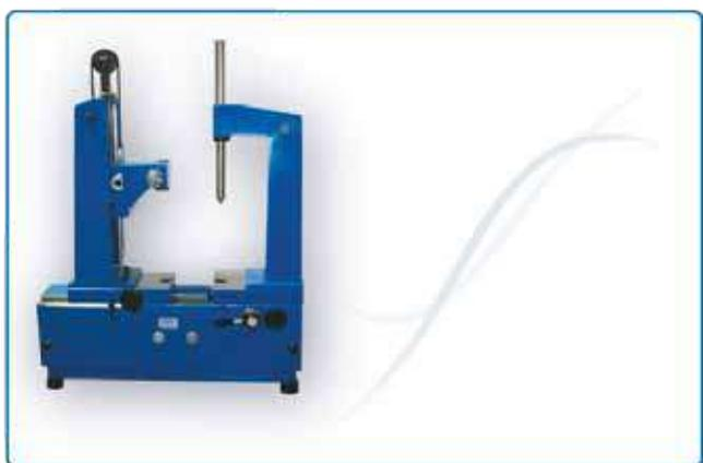
Il controllo di ingranamento è un controllo funzionale; possiamo offrire ingranometri monofianco o bifianco. Il bifianco è indicato per il controllo di ingranaggi cilindrici, il monofianco per il controllo di ingranaggi cilindrici, vite-corno e conici; viene eseguito con master di misura o ingranaggio coppia. La valutazione dei risultati dipende dal sistema di misura installato sullo strumento.
