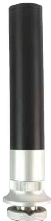
Durometro portatile senza fili che opera attraverso il metodo a ultrasuoni UCI (*Ultrasonic Contact Impedance*).
