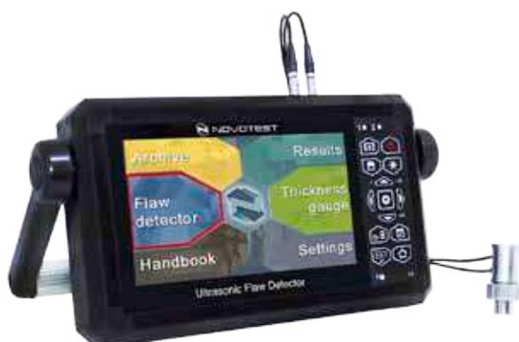
Il rilevatore di difetti a ultrasuoni **UD3701** è progettato per rilevare difetti interni, come discontinuità ed eterogeneità dei materiali in prodotti e saldature; determinare le coordinate e valutare i parametri dei difetti; misurare lo spessore e la velocità di propagazione e attenuazione delle onde ultrasoniche nei materiali (metalli, plastiche, vetro, ecc.); ricercare punti di corrosione, crepe, delaminazione interna e altri difetti.
