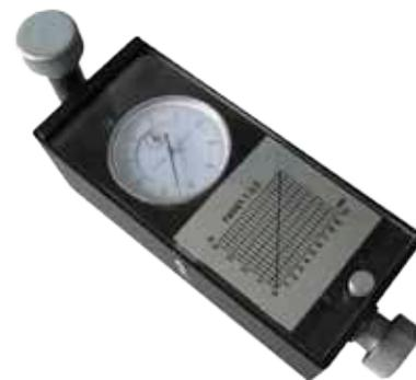
Misuratore di adesione di isolanti di bitume e mastice
